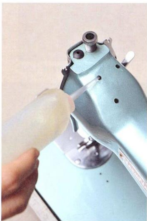
將針車油點入縫紉機上的小洞。
